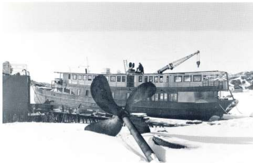
En bild från Rönning efter ett lika höftigt som oväntat snöfall. Tjörnarvet har många i arbete, inredningen är snart färdig men utvändigt återstår mycket bland annat den vita färgen, rigg och skorsten. I förgrunden den gamla ångbåtspropellern med tillhörande rest av axeln. Foto: Bo Starmark.
