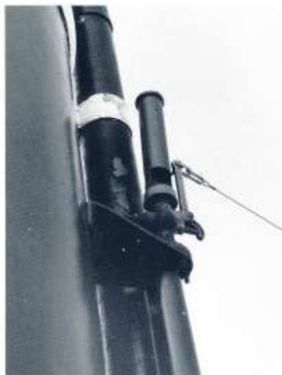
Det något skamfilade röret mellan ångvisslan och skorstenen är ångröret från säkerhetsventilerna. Ångmolnen från visslan går hårt åt färgen. Foto: Bo Starmark.
